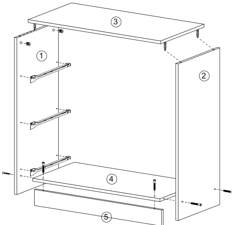
1. Сборка производится горизонтально, тыльной стороной вниз. Предварительно на боковины 1 и 2 установить направляющие 400 мм с помощью евровинтов 6,3\*10,5 мм.
