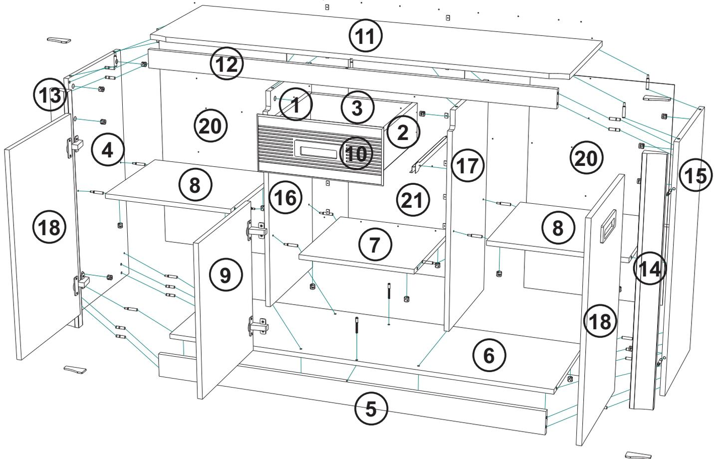
Внимательно ознакомьтесь со схемой сборки, сверяясь с комплектующей ведомостью на изделие. Согласно комплектующей ведомости определите расположение деталей в изделии и порядок их сборки. Сборка производится на ровном полу, укрытом материалом, предотвращающим повреждение покрытия пола и деталей мебели. Подготовьте необходимые для сборки инструменты.
